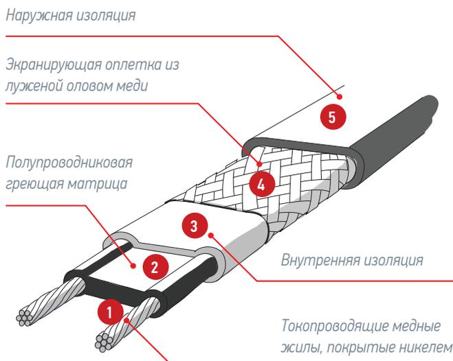
1. BUS WIRE NICKEL PLATED COPPER WIRE (токоведущие медные жилы, покрытые никелем)
