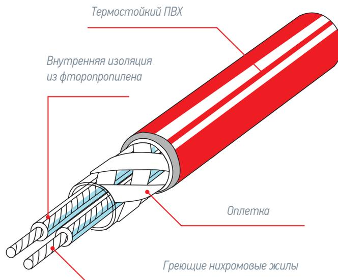
При установке системы «тёплый пол» все пространство обогревается равномерно, что особенно важно для помещений, где находятся дети. Благодаря равномерному распределению тепла в комнате не возникают сквозняки и воздушные вихри с микрочастицами пыли. Система теплого пола Lavita очень проста в эксплуатации. Работа нагревательного кабеля управляется через терморегулятор, с помощью которого задается желаемая температура поверхности пола.
